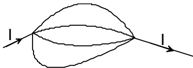
Abb. 2.7: Zur 2. Kirchhoffschen Regel: Schleifen zwischen zwei Knoten.
